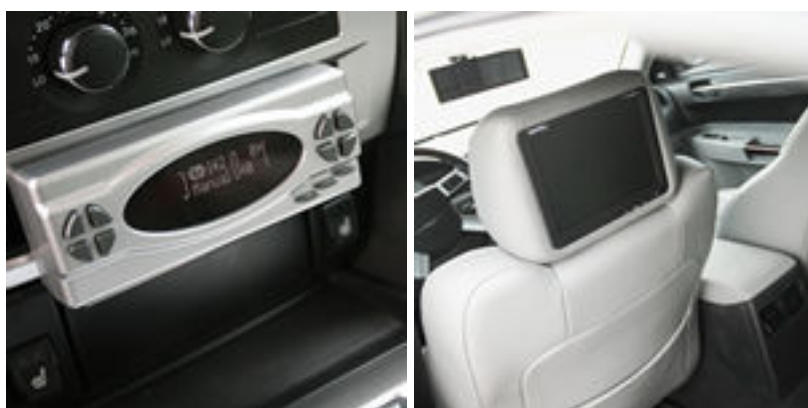
Nos bancos traseiros há telas de DVD que exibem mensagens de pesar aos familiares. Acima, os comandos da suspensão a ar
